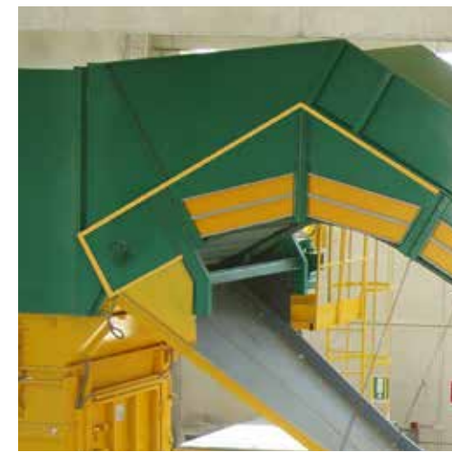
CABEÇA MOTORIZADA COM INCLINAÇÃO DE 60°
