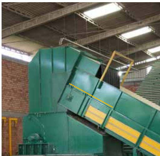
CABEÇA MOTORIZADA COM INCLINAÇÃO DE 0°
