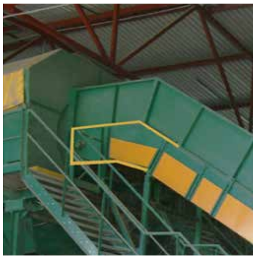
CABEÇA MOTORIZADA COM INCLINAÇÃO DE 30°
