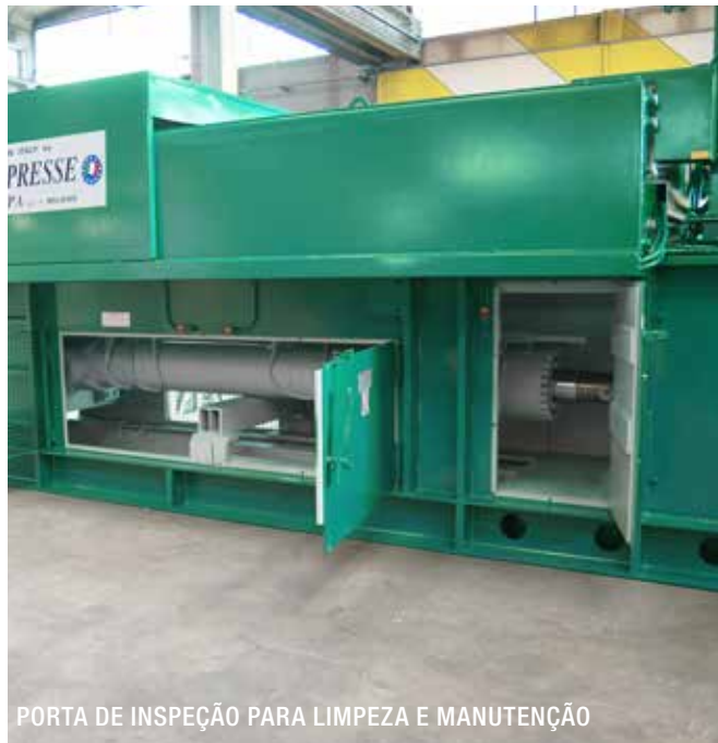
CABINA DE INSONORIZAÇÃO E PROTEÇÃO CONTRA AS POEIRAS
