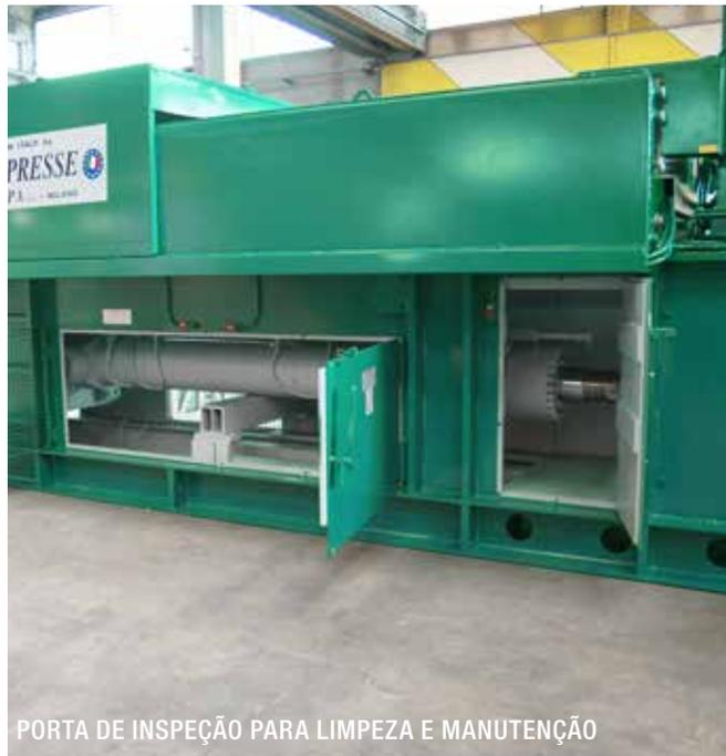
PORTA DE INSPEÇÃO PARA LIMPEZA E MANUTENÇÃO
