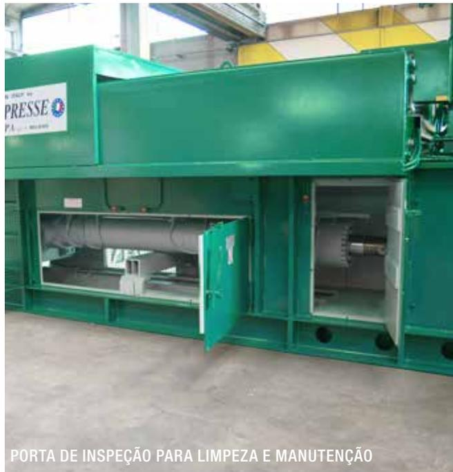
PORTA DE INSPEÇÃO PARA LIMPEZA E MANUTENÇÃO
